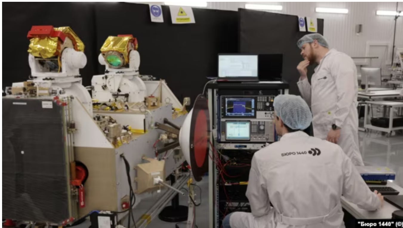
Работа над межспутниковой лазерной связью
