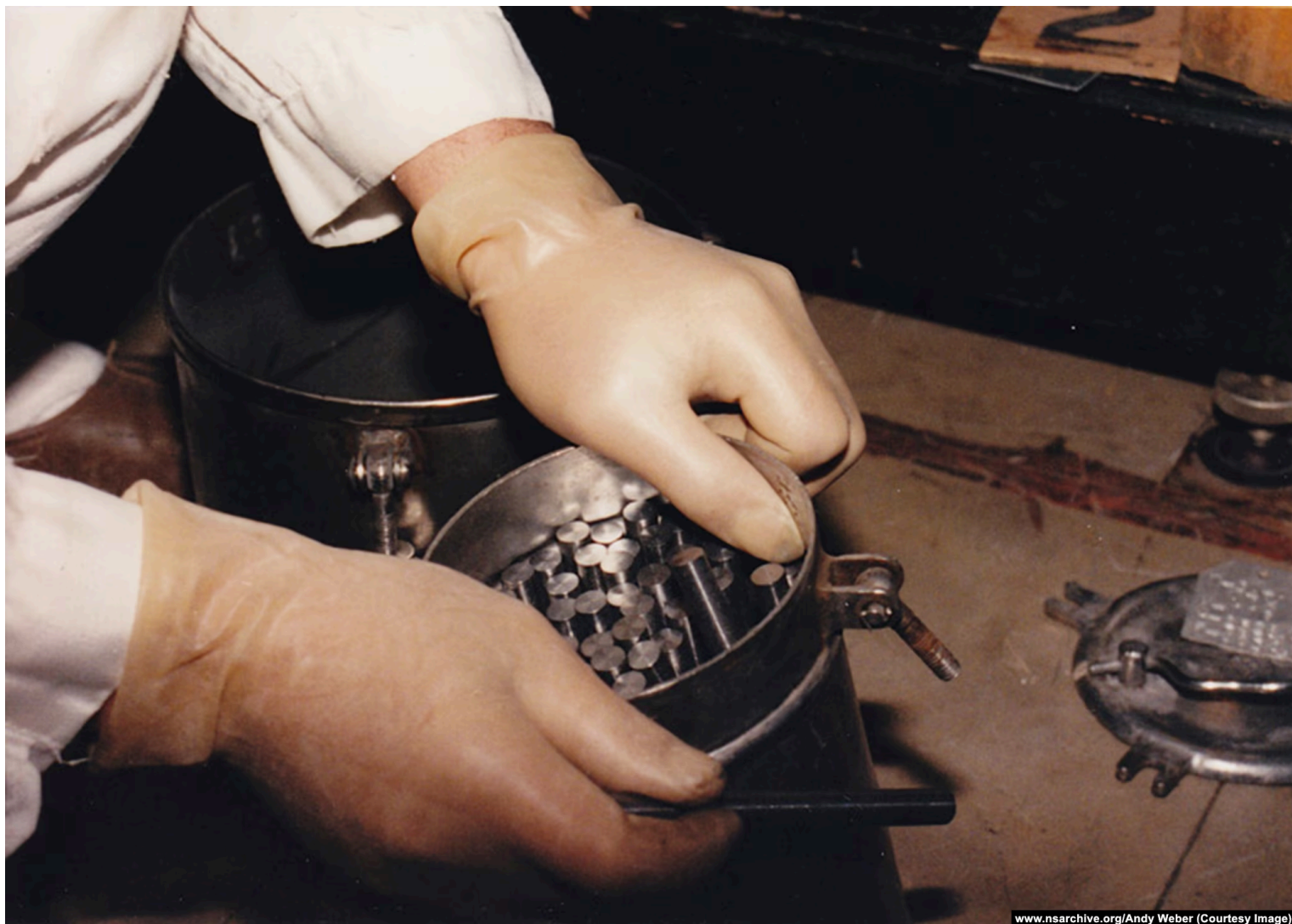
Контейнер со стержнями из высокообогащенного урана внутри Ульбинского металлургического завода.
